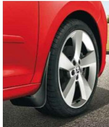
De solides **pare-boue avant** protègent le dessous du véhicule, les pare-chocs et les seuils de porte de la saleté et des projections de cailloux dangereuses (5JA 071 111)
