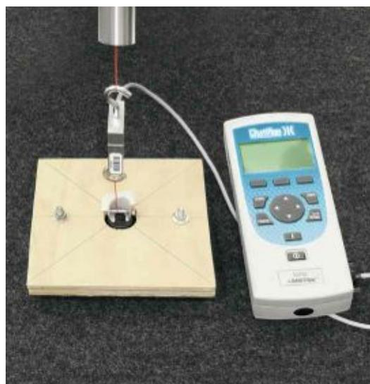
Dispositif de test du talon aiguille
