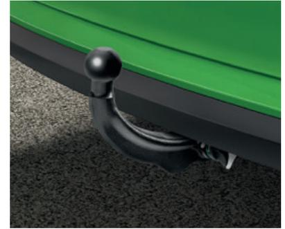
L'**attelage amovible** est idéal pour tracter occasionnellement une caravane. Il peut être retiré à tout moment afin de réduire la longueur du véhicule et de renforcer la sécurité en cas d'accident. (5JJ 092 155)
