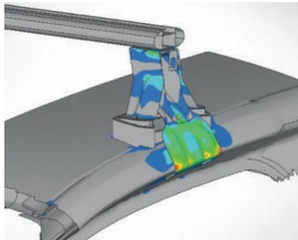
Carte de simulation de la tension induite par une contrainte imposée aux barres de toit
