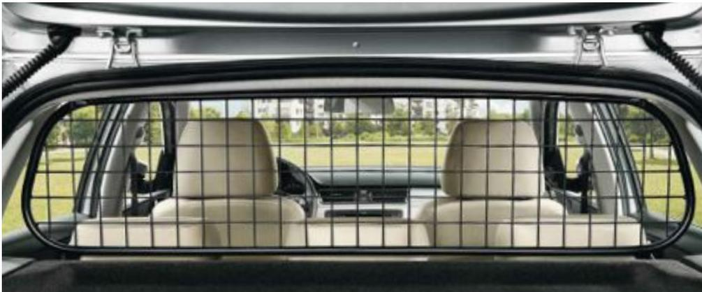
La **grille de coffre** sépare les passagers du coffre pour plus de sécurité en cas de déplacement des bagages pendant les manœuvres d'urgence. Elle ne réduit en rien le volume de l'habitacle, n'entrave pas la vue du conducteur et est adaptée au transport d'animaux (5JJ 071 221)
