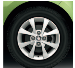
Jantes en alliage Apus 5.0J x 14" pour pneus 175/65 R14 coloris argent métallisé (1ST071494D)
